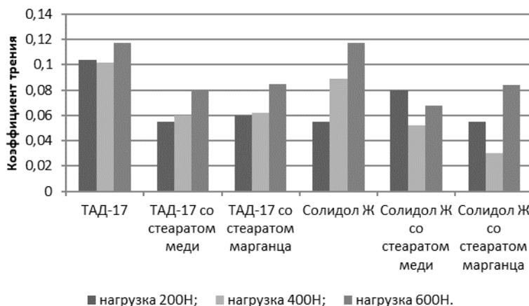
Рис. 1. Результаты определения коэффициента трения
