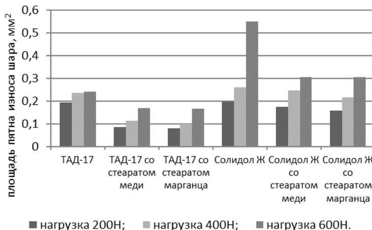
Рис. 2. Результаты определения износа шара
